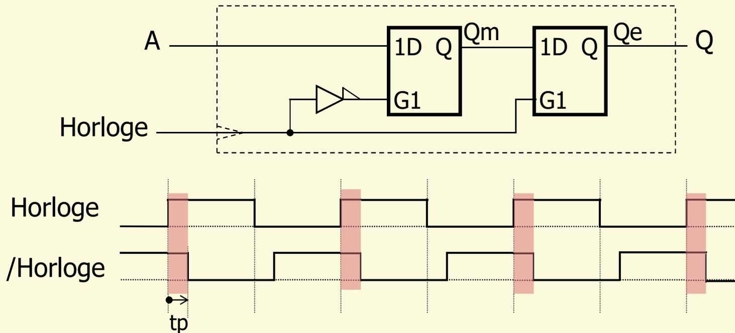
Zone où les 2 latches sont ouverts. Risque que l'état de l'entrée A passe à travers les 2 latches simultanément !
