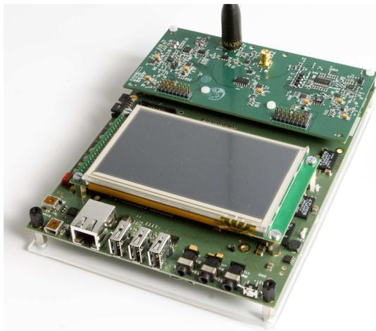
La carte possède un système de reconfiguration globale, qui permet de changer quasi instantanément une application et un circuit de traitement associé dans la FPGA.
