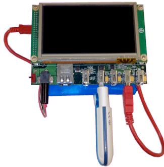
La topologie (cartes) du bâtiment est stockée dans le système mobile. La position de la personne peut être ainsi déduite des informations sur les mouvements de celle-ci. La position de la personne est affichée graphiquement sur un écran LCD du système embarqué et sur un PC distant (transmission WLAN).
